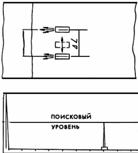
Рис.П14.7. Схема измерения условной протяженности дефекта
